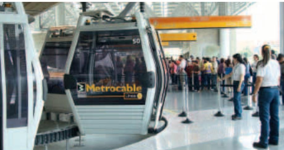
EN EL 2004 INICIÓ LA OPERACIÓN DEL METROCABLE LÍNEA K, UN SISTEMA CIRCULANTE DE GÓNDOLA MONOCABLE DESENGANCHABLE CON CAPACIDAD DE MOVILIZAR 3 MIL PASAJEROS POR HORA
