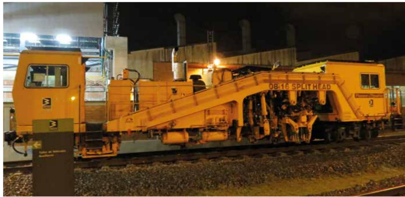
La bateadora puede corregir la geometría de la vía y la consolida para evitar el hundimiento que se produce por la carga. Por noche se pueden batear 800 metros de vía.
