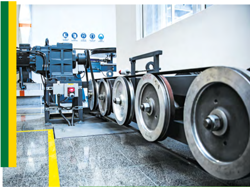
Este sistema simula la cadencia del Metrocable, o sea la correcta separación de las cabinas durante la operación
