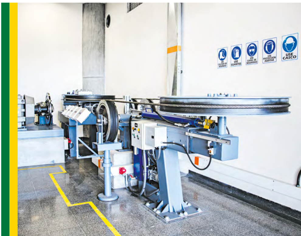
Este sistema simula una volante de estación terminal, con el respectivo módulo de tensión, tal como los existentes en las estaciones Santo Domingo, San Javier, Villa Sierra y Santo Domingo de línea L.
